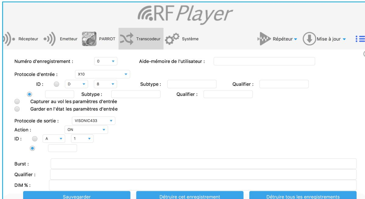
La fonction de transcodage est utilisée par le Répéteur et constitue une sous-fonction de celui-ci. Le flux de données est le suivant : RF protocole A → transcodage → RF protocole B.
